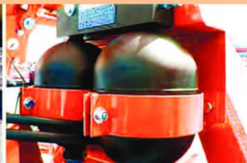
ОХЛАЖДЕНИЕ ГИДРАВЛИКИ, АЗОТНЫЙ АККУМУЛЯТОР
