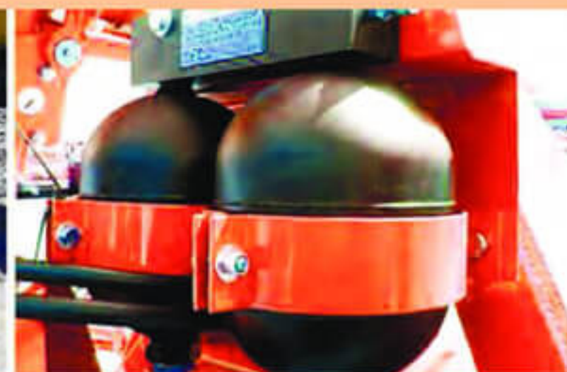
ОХЛАЖДЕНИЕ ГИДРАВЛИКИ, АЗОТНЫЙ АККУМУЛЯТОР
